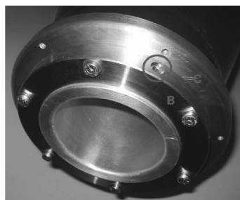
图11 固定环上增加的防松螺钉
